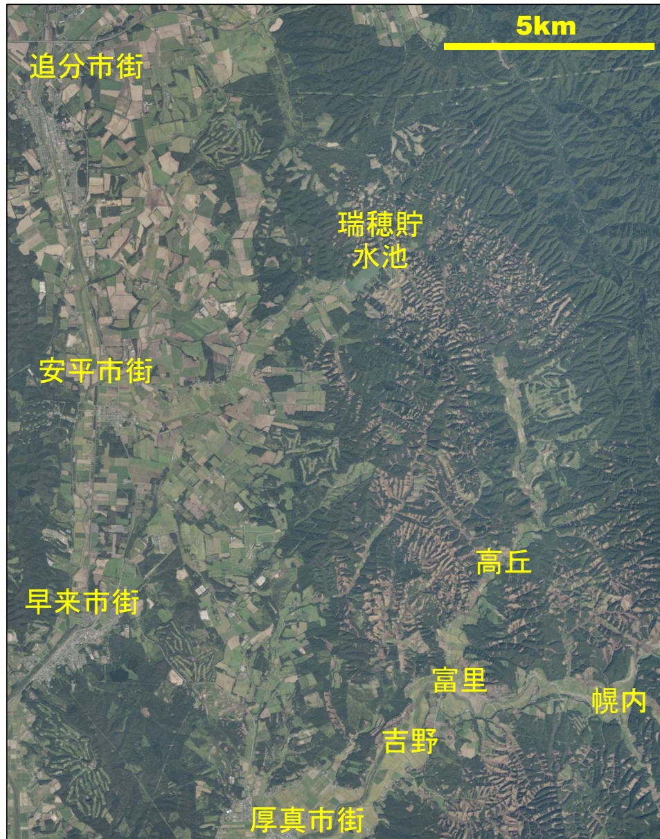
図3 胆振東部地震による厚真町中・北部とその周辺地域で発生した多発崩壊。 国土地理院2018.9.11撮影空中写真「安平地区」使用。
